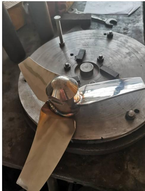
从搅拌器的功能可以知道，叶轮的大小不是任意决定的，它可以影响叶轮的排出流量，也可以影响动力消耗，也就是可以影响向液体中输入能量的大小，说明叶轮的大小直接影响搅拌过程所需要动力，还能提供良好的流动状态，完成预期的操作。叶轮的大小一般以桨径的大小（所谓桨径是指叶轮回转时前端轨迹圆的直径）和叶轮的宽度来衡量。桨径的选择与搅拌器的种类有关，与罐径的大小有关。当搅拌罐中出现“圆柱状回转区”时，这个部分的混合很差，致使混合时间较长，不利于搅拌过程，所以一般都要设法缩小这个区域。如果减小桨径就可以缩小“圆柱状回转区”的半径。在低黏度液时，由于液体流动性好，能量传递较容易，所以不必担心由于液体流动性好，能量传递较容易，所以不必担心由于桨径的减小会造成叶轮外围出现死区。此时，只要叶轮的搅动液量范围够，就应将桨径取小些。
